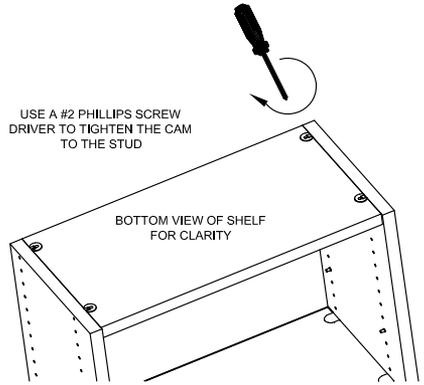
USE A #2 PHILLIPS SCREW DRIVER TO TIGHTEN THE CAM TO THE STUD
